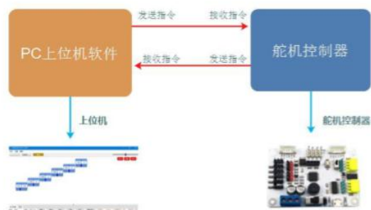
图4 上位机与舵机控制器通信示意图
