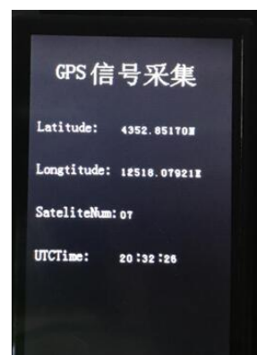
图 5 GPS 信号采集结果图（按行依次显示纬度、精度、解析卫星数、时间）
