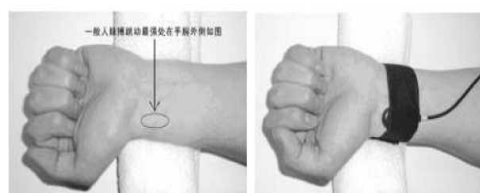
图 3 HK-2000B 脉搏传感器固定方法
