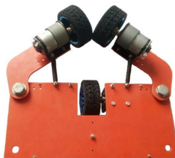
图 3 爬杆机器人结构实物图
