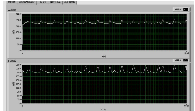
图 11 滤波后脉搏波信号波形
