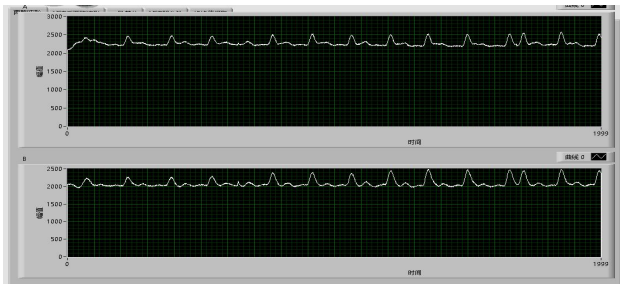
图 10 脉搏波信号原始波形
