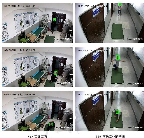
图 7 不同场景下的人脸正确跟踪: (a) 实验室内, (b) 实验室外的楼道
