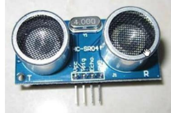
图 2 HC-SR04 模块实物图
